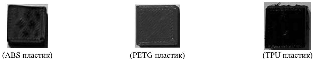
Рисунок 1 – Внешний вид поверхности после 3D печати использованных видов полимеров
