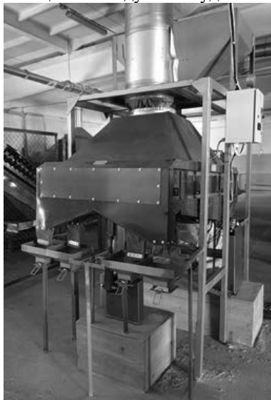
Рисунок 1 – Общий вид прямооточного вибропневматического сепаратора ПВС-500
