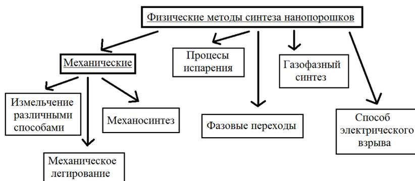
Рис. 1. Физические методы синтеза нанопорошков
