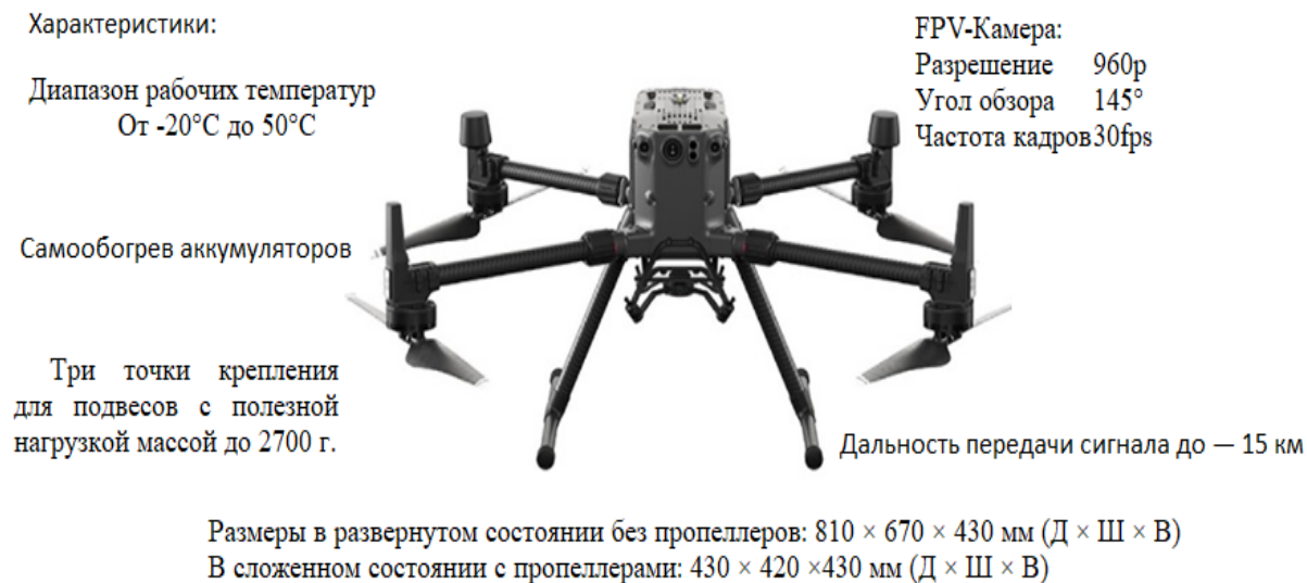
Рис. 1. Квадрокоптер DJI Matrice 300 и его характеристики [0]
