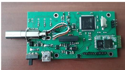
Рис. 1. Модуль конвертера Bluetooth для беспроводных сенсорных устройств
