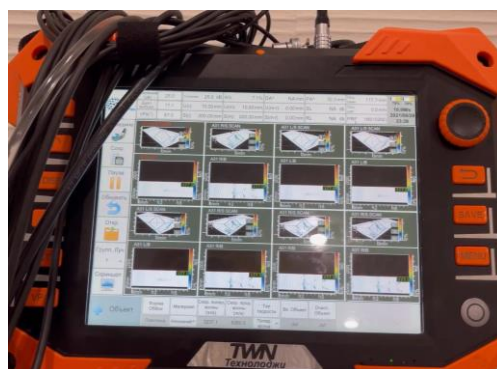
Рис. 2. Отображение сканов на экране дефектоскопа
