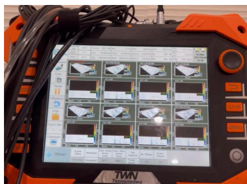
Рис. 2. Отображение сканов на экране дефектоскопа
