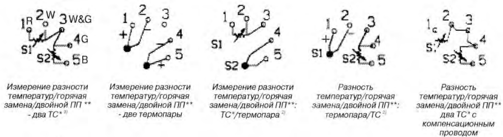
Рис.11. Схема подключения двойного первичного преобразователя к Rosemount 3144P-Foundation fieldbus.
