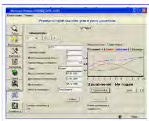
Рис. 3. Метран-502-ПКД-10П. Вид окна программного обеспечения в режиме поверки (отчет)
