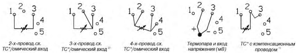
Рис.8. Схема подключения одинарного первичного преобразователя к Rosemount 3144P-HART/4-20 мА.
