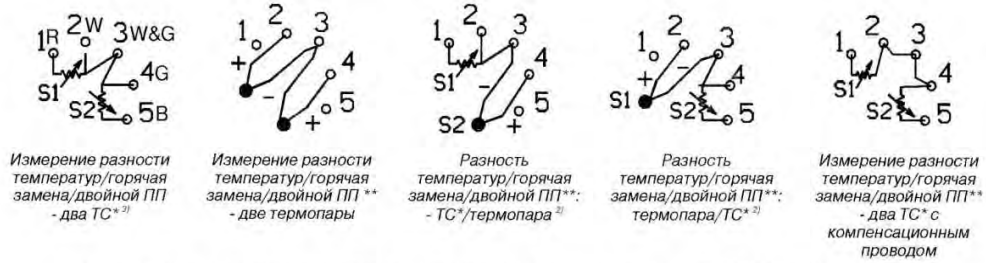
Рис.9. Схема подключения двойного первичного преобразователя к Rosemount 3144P-HART/4-20 мА.
