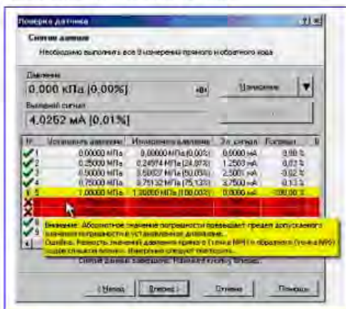
Рис. 5. Metran-510-ПКД-P. Вид окна программного обеспечения в режиме поверки
