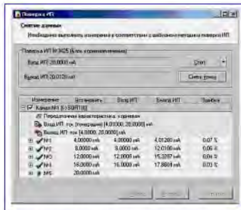
Рис. 8. Metran-510-ПКМ. Вид окна программного обеспечения в режиме получения данных об ИП
