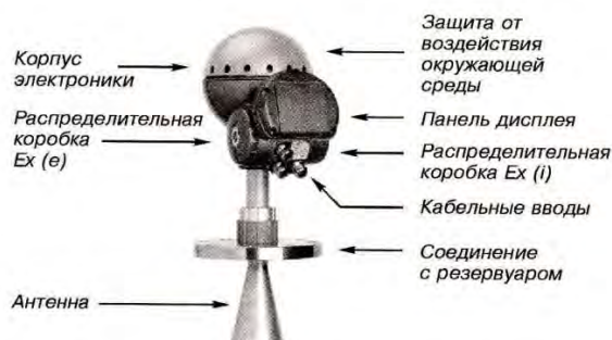
Рис. 1. Конструкция уровнемера.
