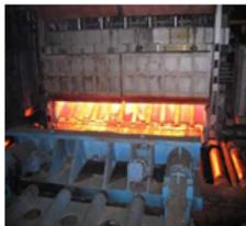
Нагревательные печи предназначены для нагрева металла перед ковкой, штамповкой или прокаткой.
