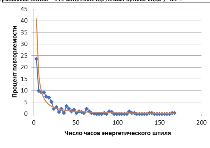
Рис.1 Статистическое распределение энергетических штилей по данным метеостанции Орша, Беларусь, выборка скоростей с 07.03.2021 по 14.03.2022 с интервалом 3 часа. Скорость страгивания ветроколеса – 3 м/с.
