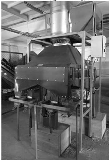
Рисунок 1 – Общий вид прямооточного вибропневматического сепаратора ПВС-500
