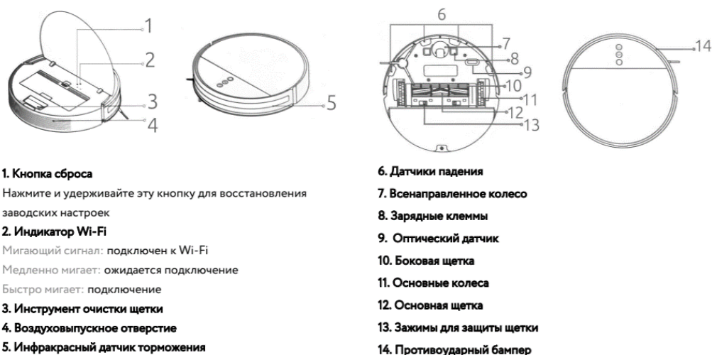
Рисунок 2 – Основное устройство робота-пылесоса
