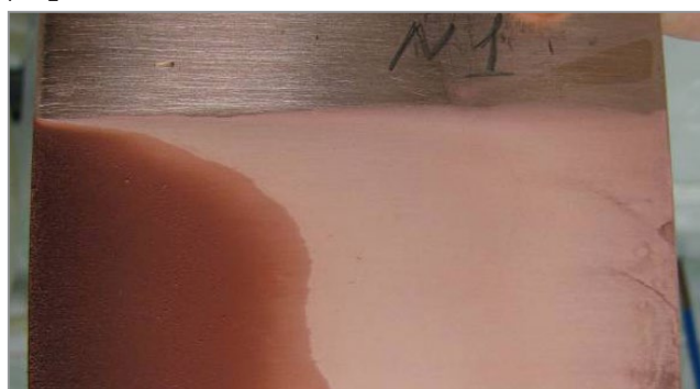
Рис. 2. Внешний вид медной катодной пластины после осаждения покрытия из сульфатного электролита кобальтирования-меднения
