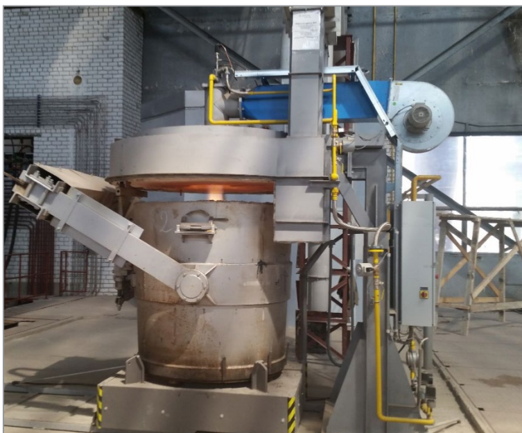
Рис. 2. Однопозиционный стенд нагрева ковшей 3 и 6 т
