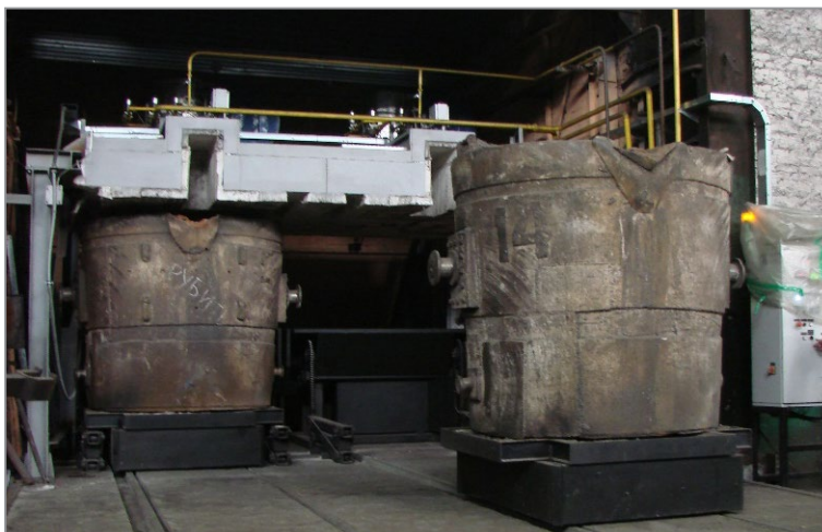
Рис. 1. Двухпозиционный стенд нагрева ковшей 6 и 8 т
