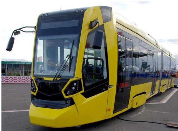
Рис. 13. Сочлененный низкопольный трамвай В85300М. Длина – 26,715 м, пассажироместность – 254 чел. (58+196)
