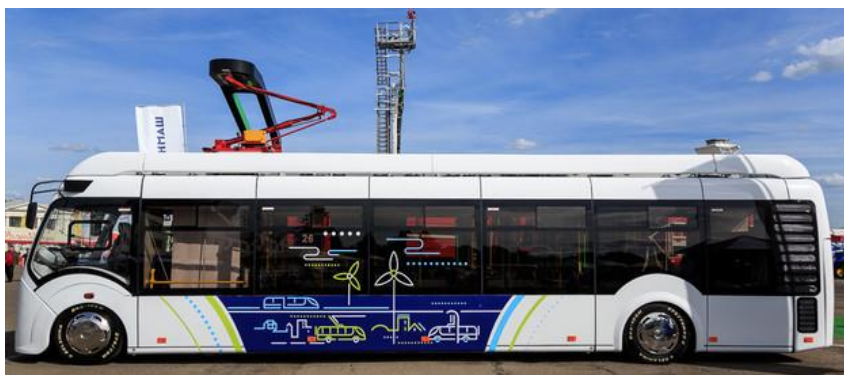
Рис. 8. Подзарядка электробуса E433 на остановке
