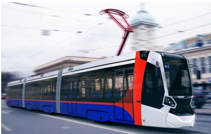
Рис. 14. Сочлененный низкопольный трамвай «Метелица» В85600М. Длина – 33,450 м, пассажироместимость – 370 чел. (66+304)
