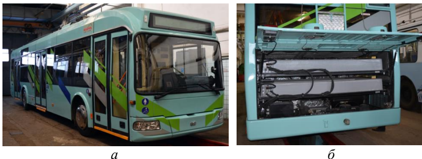
Рис. 5. Троллейбус модели 321 с аккумуляторными батареями: а – внешний вид; б – установка аккумуляторных батарей
