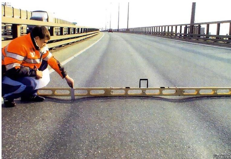
Рис. П25. Колея на покрытии до 30 мм без значительных дефектов
