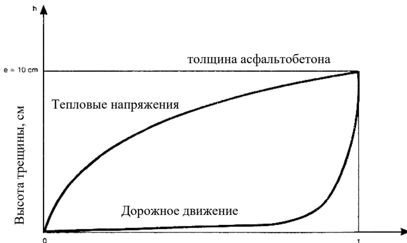
Рис. П8. Развитие температурных трещин
