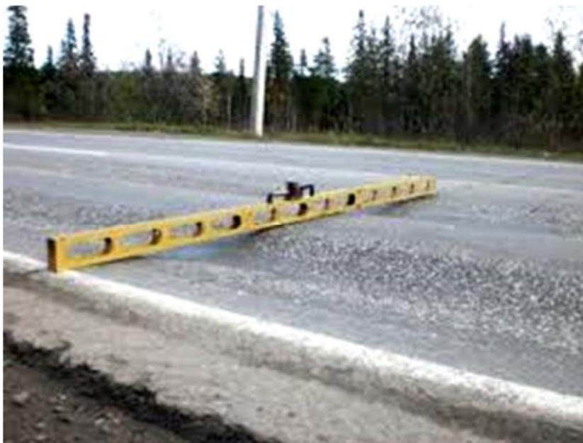
Рис. П28. Колея на покрытии более 30 мм с волнами
