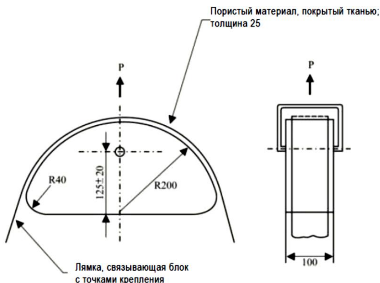
Рис. 2.2. Схема натяжного устройства
