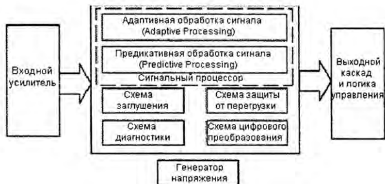
Рисунок 5. Структурная схема усилителя класса T
