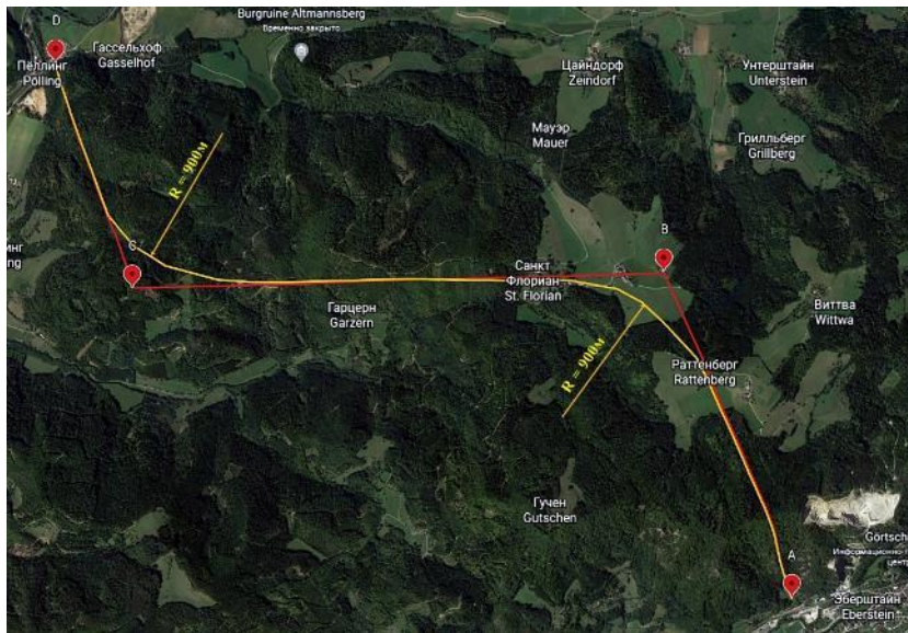
Рисунок 1 – Генеральный план тоннеля (красная линия – линия нулевых работ; жёлтая линия – принятая трасса)
