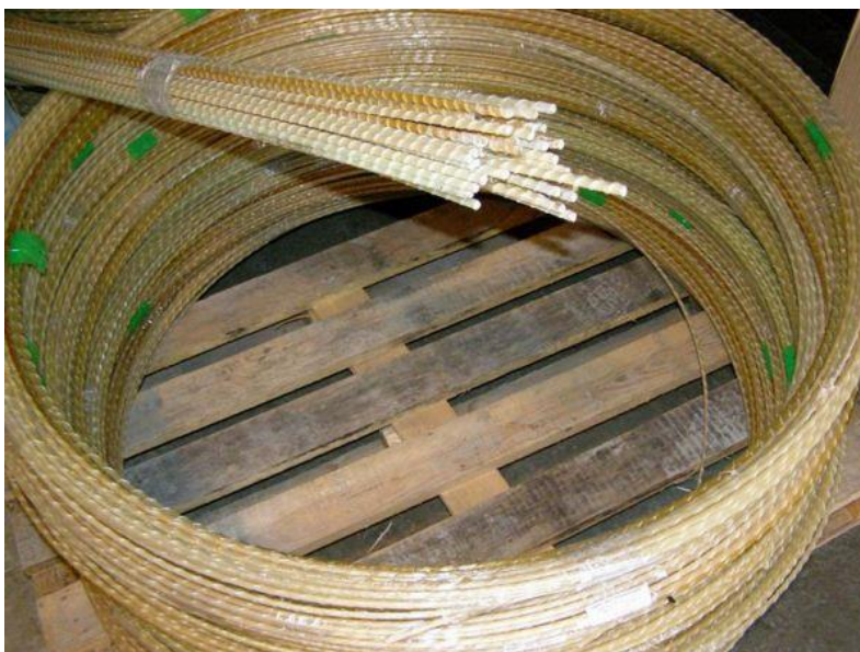
Рисунок 2 – Композитная арматура в скрученном виде
