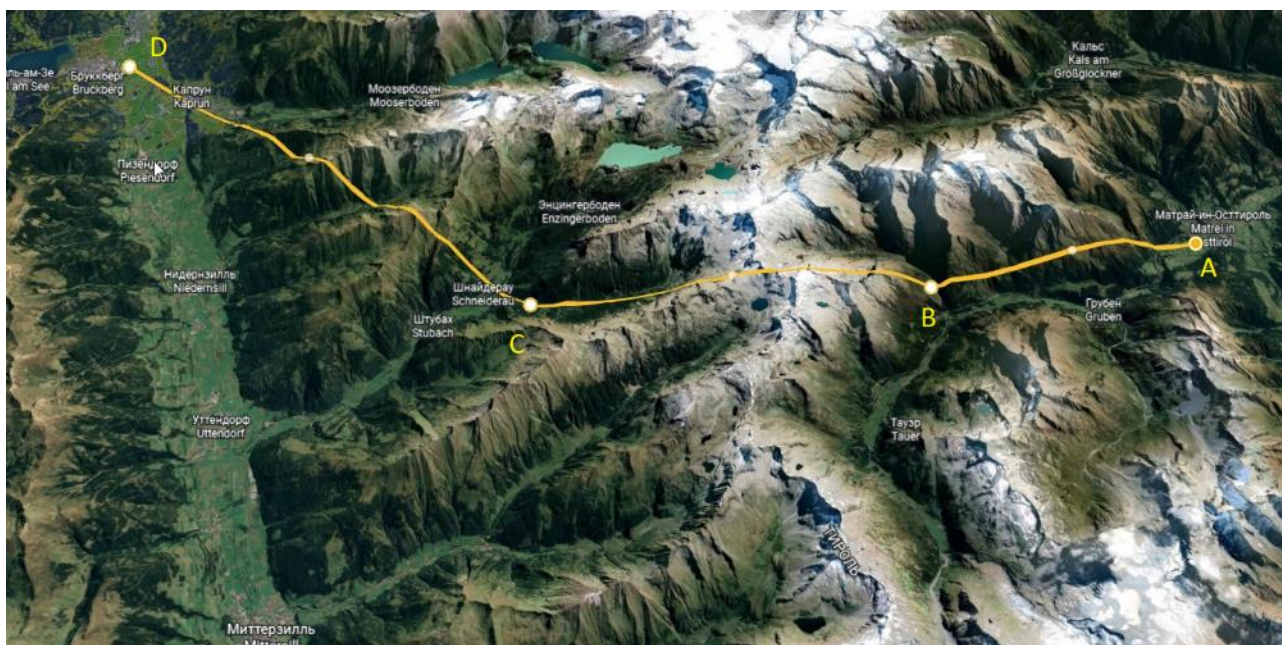
Рисунок 1 – Трассировка тоннеля и рельеф местности
