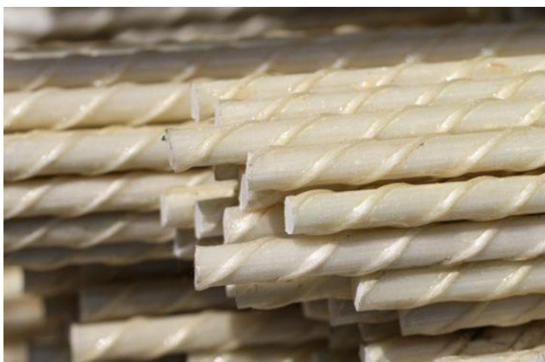
Рисунок 1 – Внешний вид композитной арматуры
