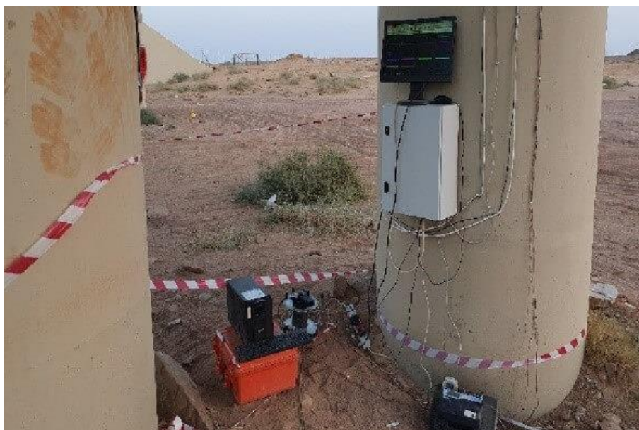
Рисунок 7 – Блок сбора данных в корпусе IP67 с программным обеспечением DewesoftX
