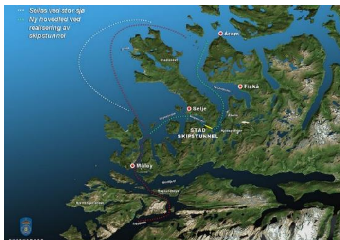
Рисунок 2 – Жёлтой чертой на карте указан тоннель, а пунктиром обозначены пути, которыми пользуются суда в данный момент
