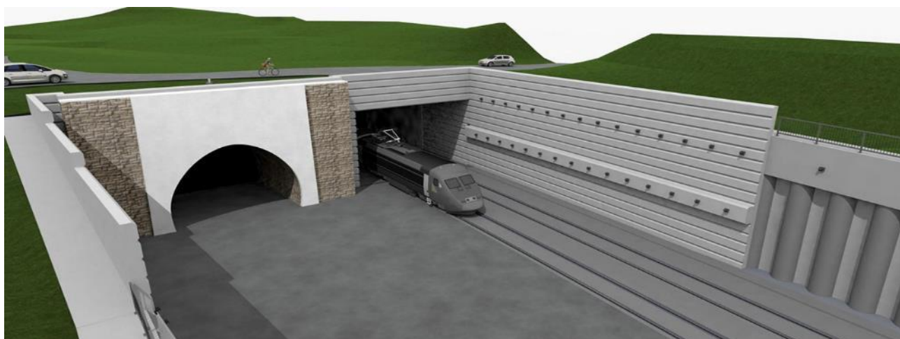
Рисунок 3 – Портал тоннеля. Выполнен в программе Revit
