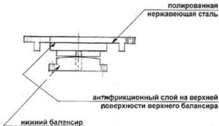
Рисунок 2 – Тангенциальная скользящая опорная часть
