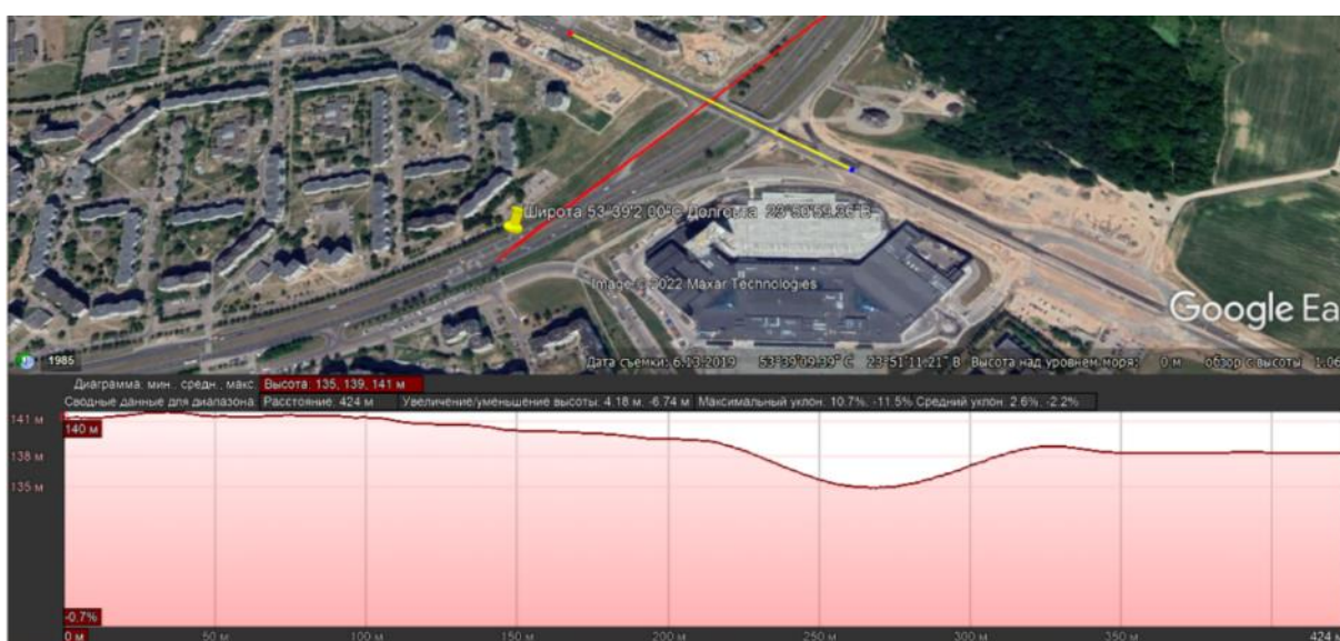
Рисунок 2 – Продольный профиль местности при помощи Google Earth
