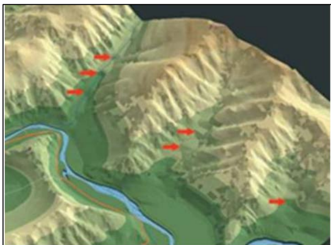
Рис.21. «Эффект террас» в долинах малых рек, возникающий при создании TIN на основе горизонталей без учёта структурных линий рельефа (в данном случае - гидросети)
