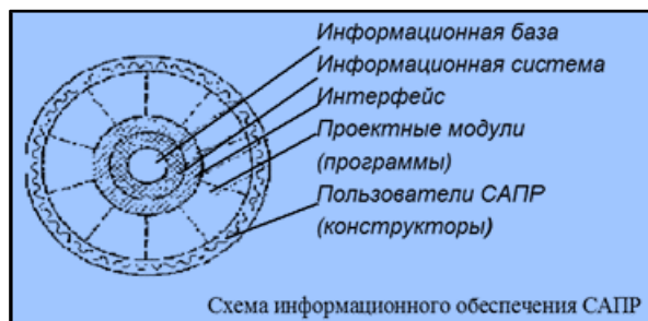
Рис. 1. Схема информационного обеспечения САПР
