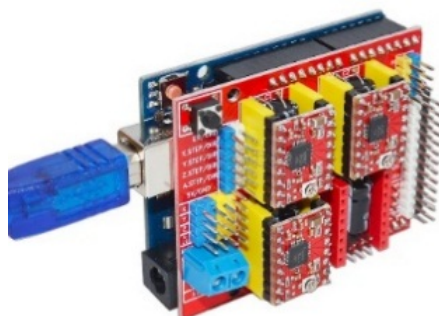
Рисунок 6 – Электрическая система управления фрезерным станком в сборе
