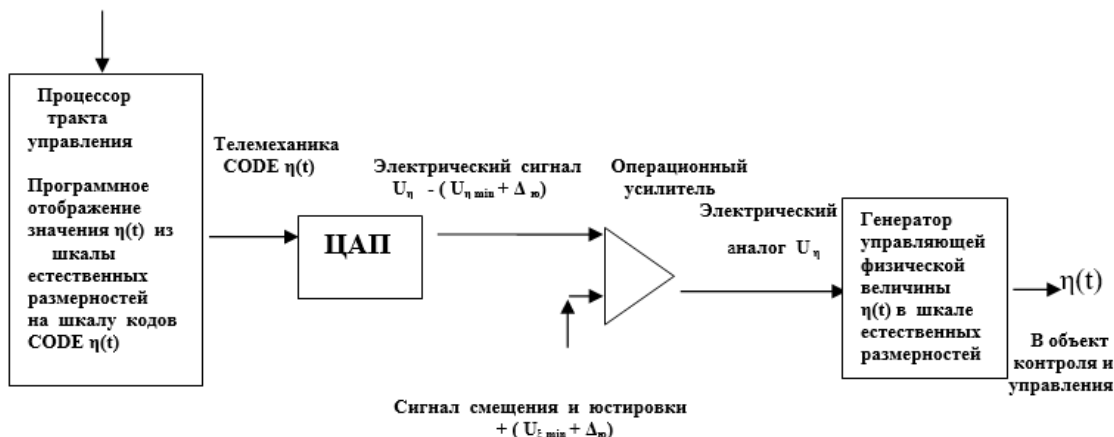
Рисунок 2. Тракт формирования и передачи данных управления
