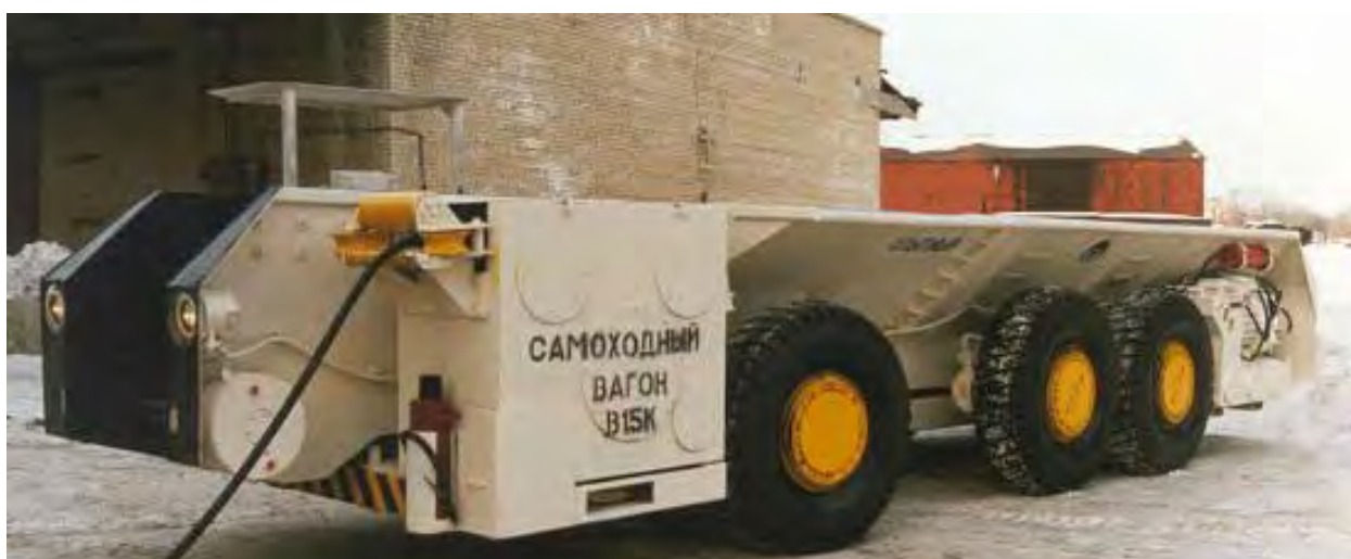
Рисунок 4.15 - Самоходный вагон B15K (схема 6x3)
