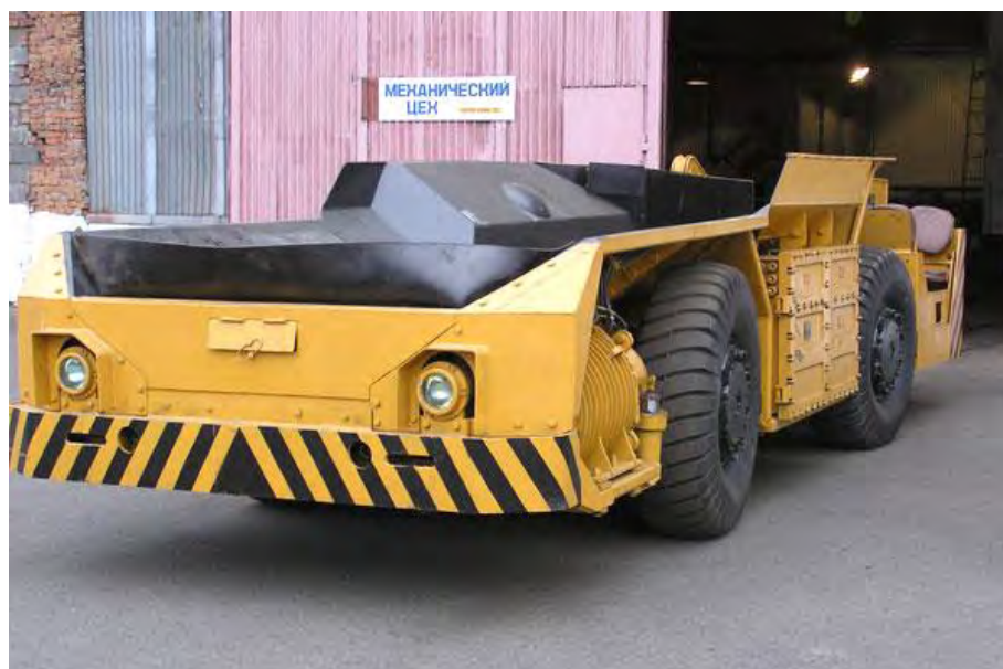
Рисунок 4.14 - Вагон самоходный 5BC15М (схема «кран»)
