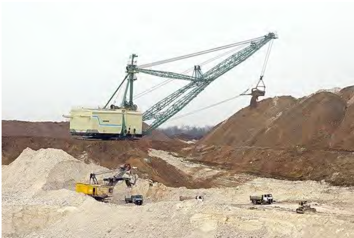
Рисунок 1.4 – Технологический комплекс машин на карьере по добыче мела
