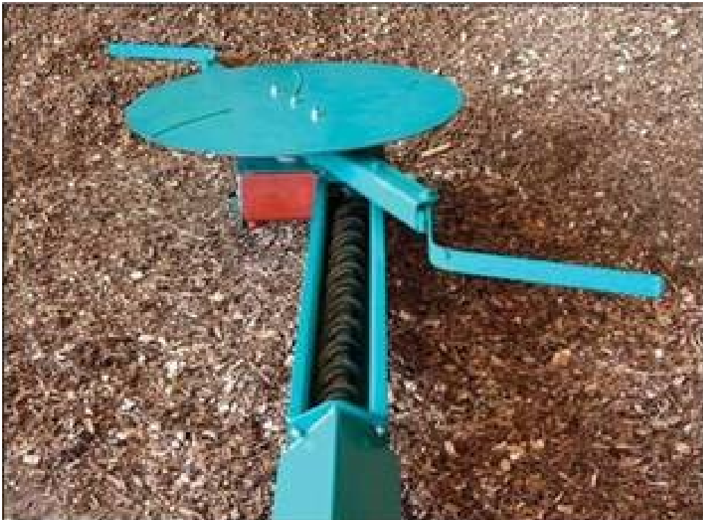
Рисунок 3 - Фреза для подачи щепы, опилок и гранул.
