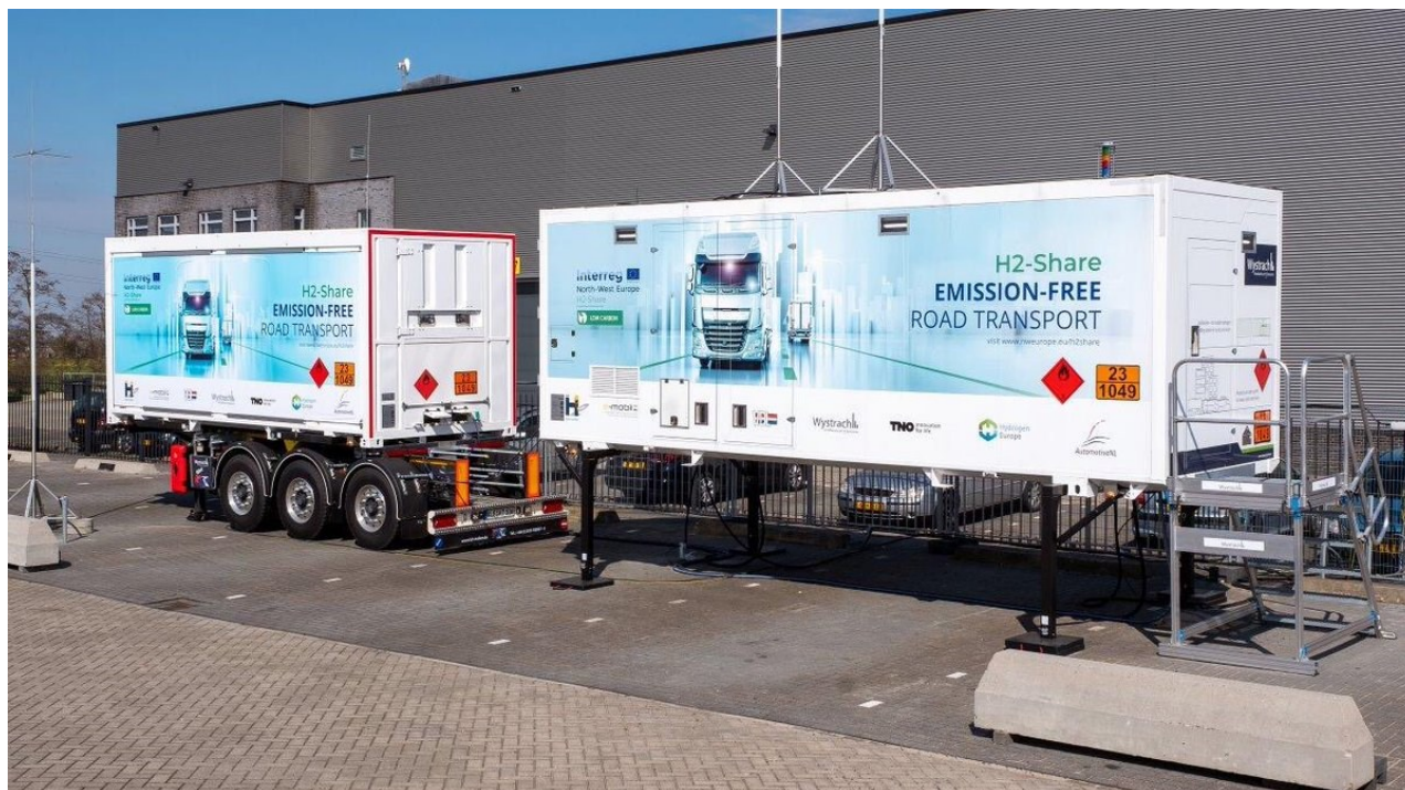
Рисунок 2 - Мобильная водородная заправочная станция
