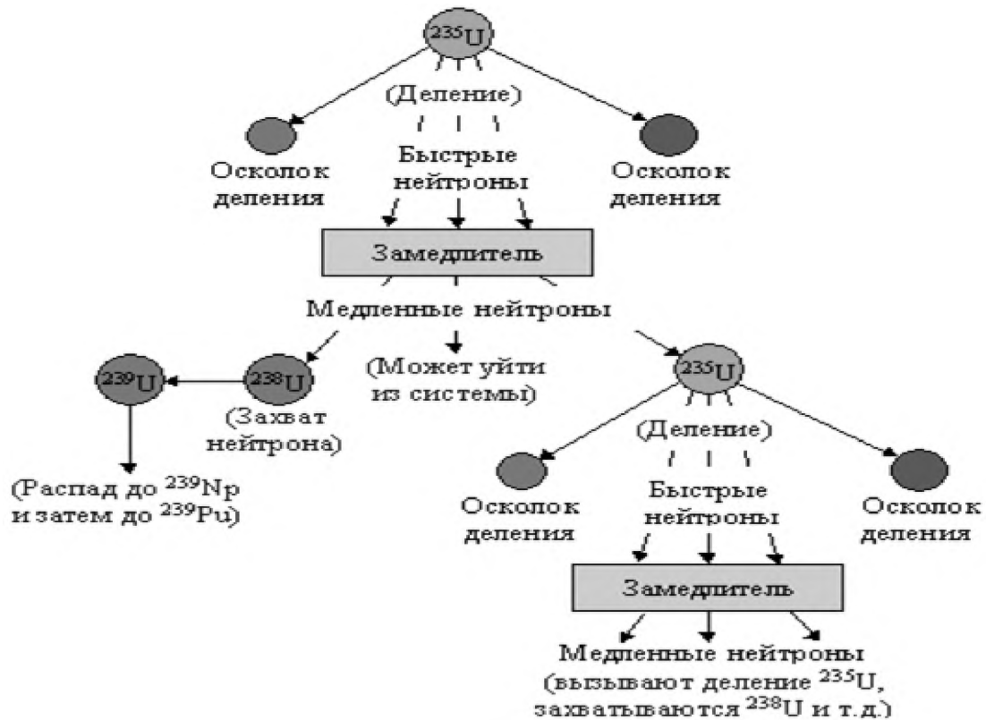
Рис. 3.1. Схема цепной реакции в среде с замедлителем
