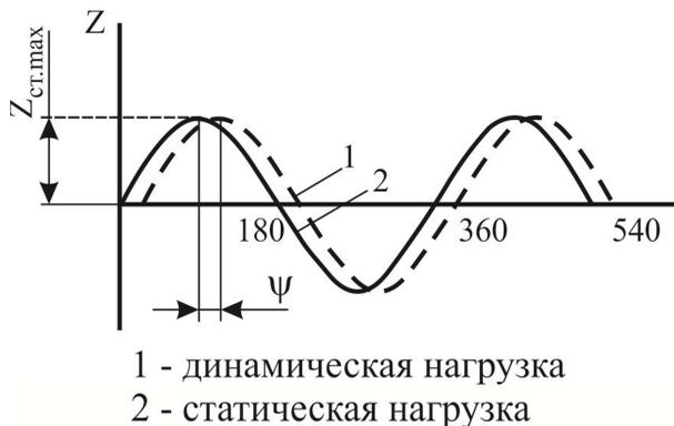
Рис. 2. Динамически изменяющаяся входная величина и ее регистрация прибором
