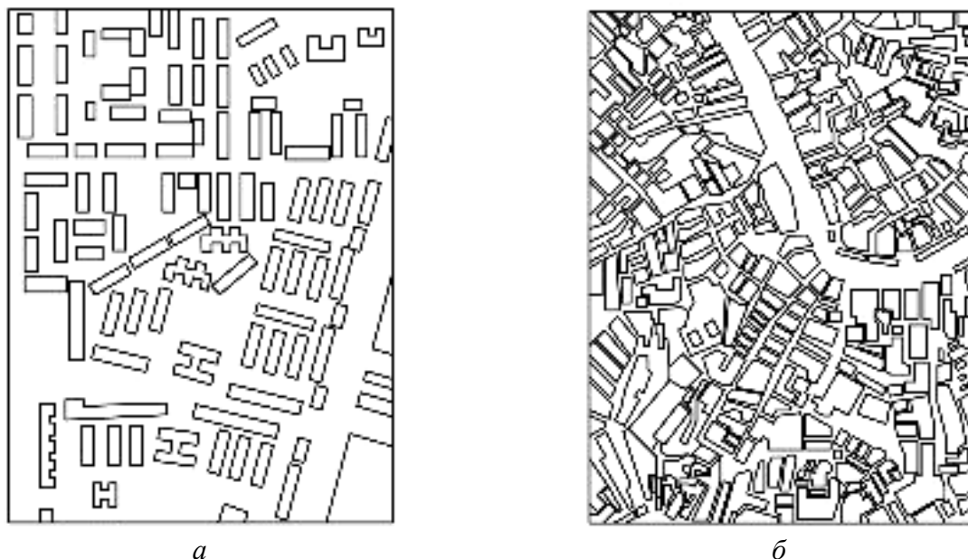
Рис. 1. Различие приемов планировки 1960–70-х гг. (а) и исторически сложившегося города (б) (по А. Э. Гутнову)
