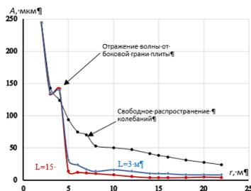
Рис. 2. Зависимость максимальной амплитуды  $A$  (мкм) колебаний от расстояния между источником и приемником колебаний  $r$  (м) при толщине бетонной плиты 2 м и длинах 3 и 15 м
