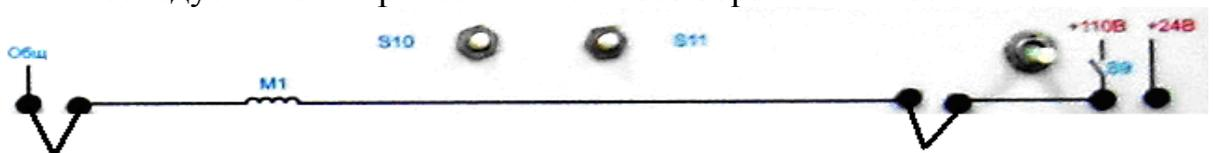
Рис. 5.2. Схема подключения обмотки возбуждения
