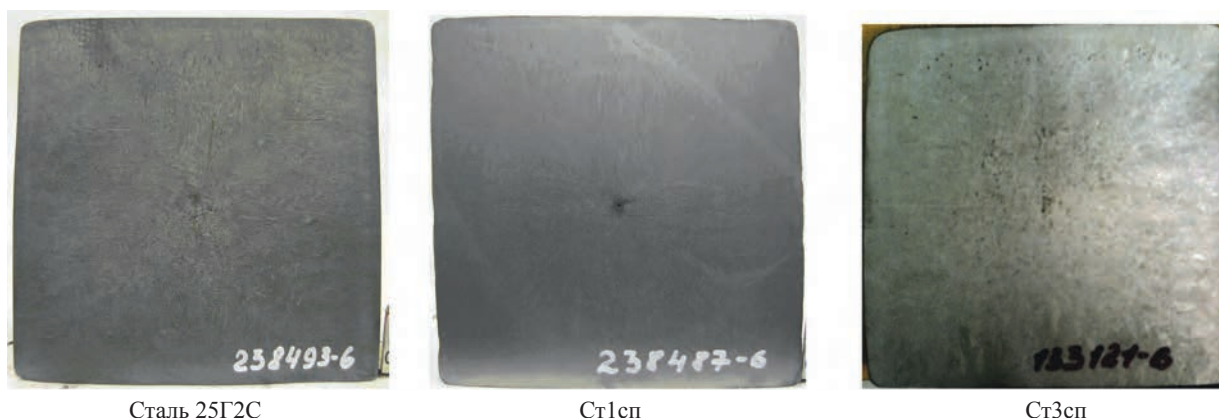
Рис. 2. Макроструктура непрерывнолитой заготовки сечением 140×140 мм с опытного ручья
