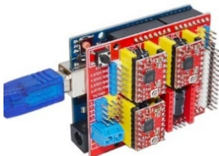
Рисунок 6 – Электрическая система управления фрезерным станком в сборе
