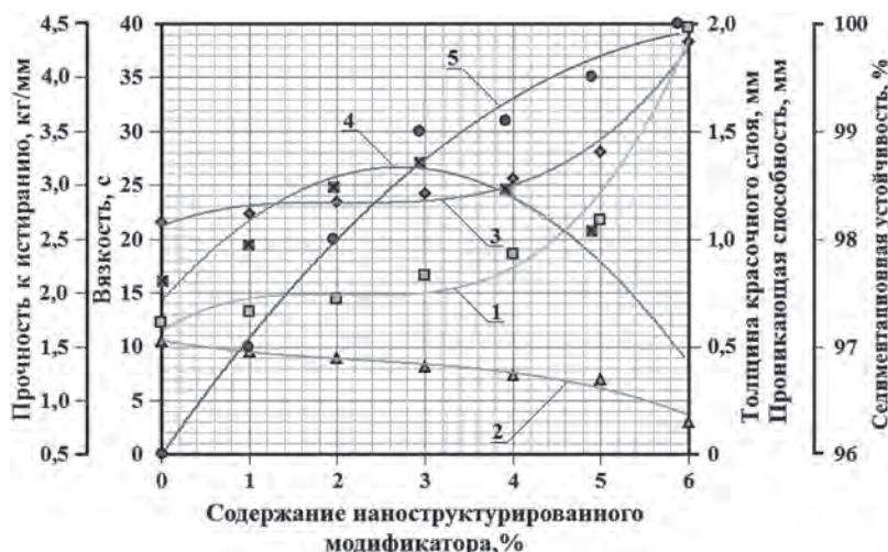
Рис. 4. Физико-механические свойства противопригарного покрытия, модифицированного наноструктурированным бемитом: 1 – толщина красочного слоя; 2 – проникающая способность; 3 – вязкость; 4 – прочность к истиранию; 5 – седиментационная устойчивость
