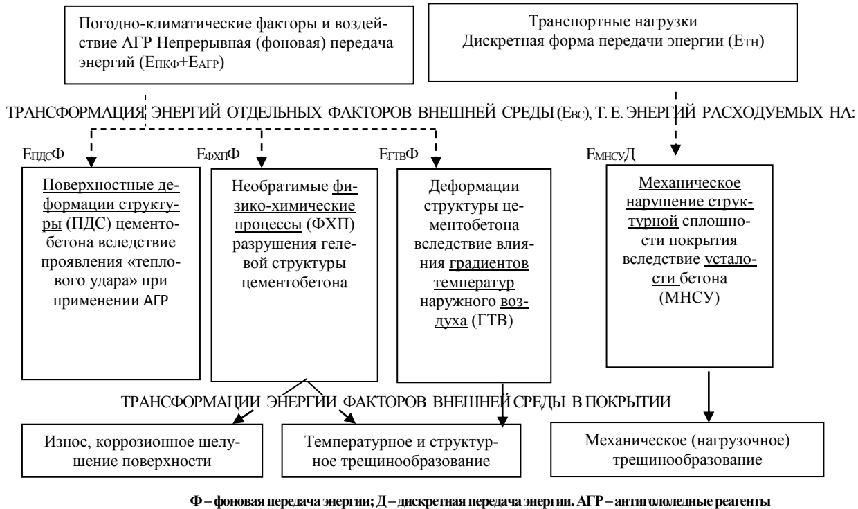
Рисунок 1. – Схема трансформации энергии факторов внешней среды в цементобетонном покрытии и образования в нем необратимых деформаций.
