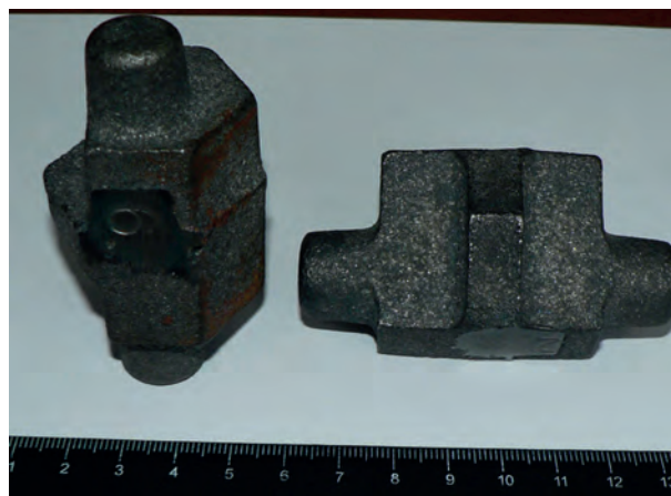
Рис. 2. Внешний вид отливок из высокопрочного чугуна ВЧ50
