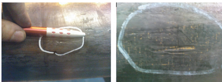
Рис. 1. Продир на оправке непрерывного стана
