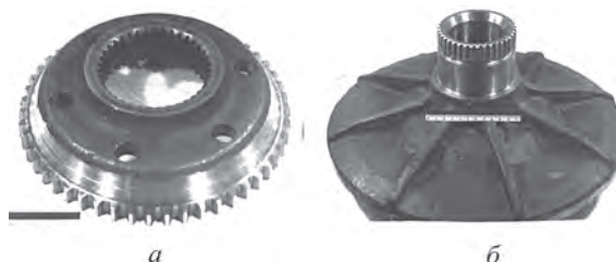
Рис. 4. Детали автомобиля МАЗ, подвергаемые импульсной закалке с целью устранения закалочных трещин и уменьшения деформаций: а – ступица водила колесной передачи; б – цапфа
