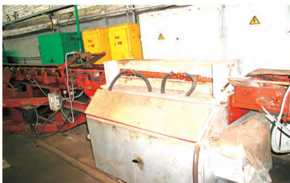
Рис. 8. Линия индукционной термообработки проката под изготовление крепежных изделий
