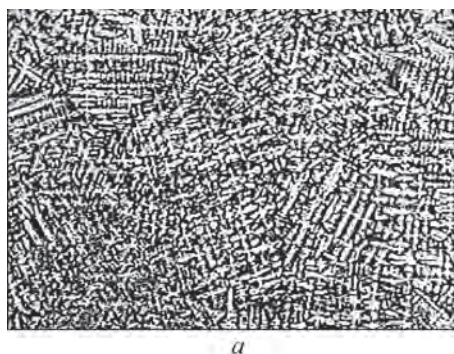
Рис. 6. Структура стальной литой дроби до термообработки (а); после термообработки (б). а – \times 125 ; б – \times 500
