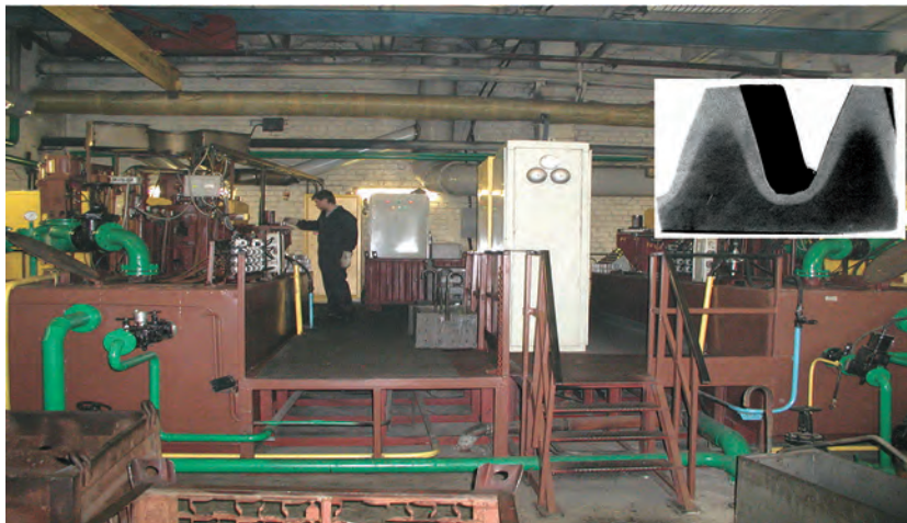
Рис. 3. Участок ТВЧ для объемно-поверхностной закалки шестерен колесной передачи автомобиля и расположение закаленной зоны в сечении зубьев
