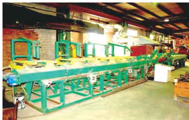
Рис. 9. Линия МАЗ термической обработки труб каркасов автобусов с применением индукционного нагрева
