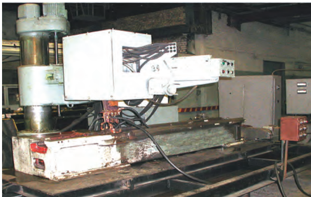
Рис. 11. Установка для поверхностной заковки с индукционным нагревом длинномерных изделий
