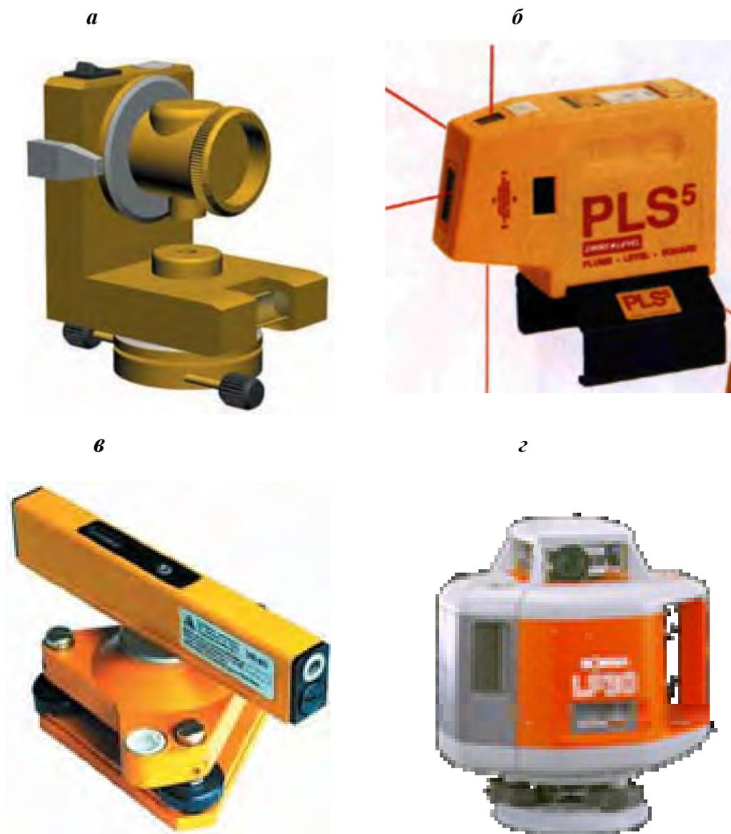
*a* – задатчик направлений ЗНЛ-01; *б, в* – лазерные уровни PLS3 и УЛ-01;
