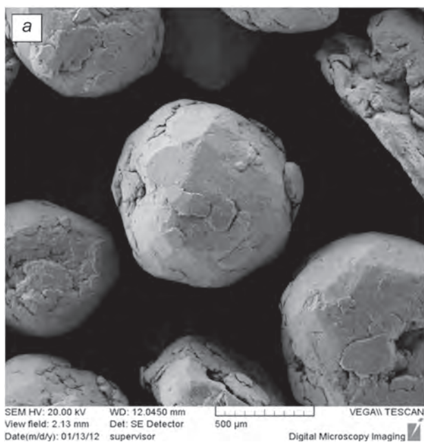
Рис. 1. Форма и топография поверхности гранул композиций, содержащих 10% (а), 20% (б) хрома
