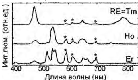
Рисунок 1 – Спектр люминесценции оксифторидной стеклокерамики с нанокристаллами \text{PbF}_2 , соактивированной ионами \text{Eu}^{3+} , \text{RE}^{3+} и \text{Yb}^{3+}
