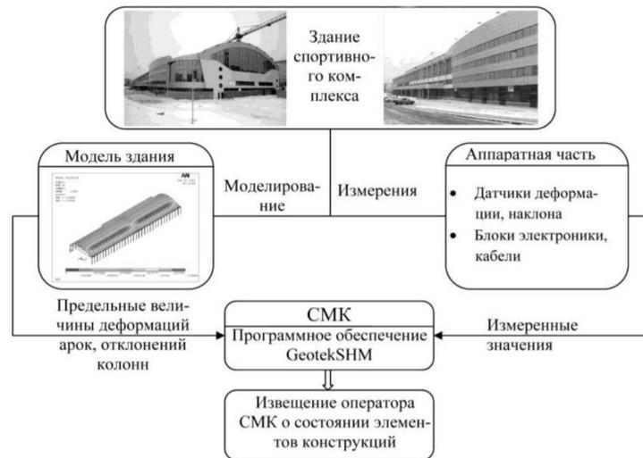
Рисунок 2 - Блок-схема взаимодействия аппаратной и расчетной частей системы мониторинга
