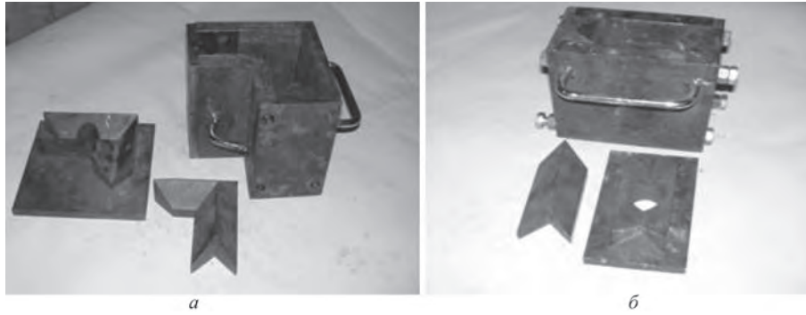
Рис. 4. Кокили для литья рядных (а) и угловых (б) свинцовых блоков
