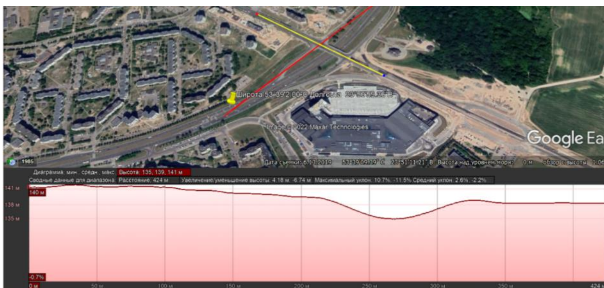
Рисунок 2 – Продольный профиль местности при помощи Google Earth
