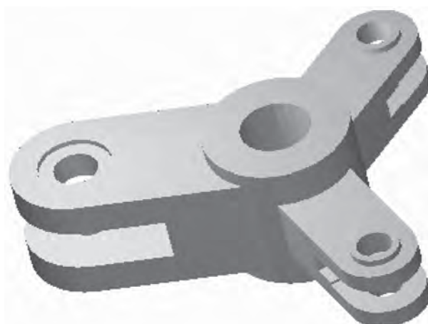
Рис. 1. 3d-модель отливки «Кулиса», используемой при моделировании
