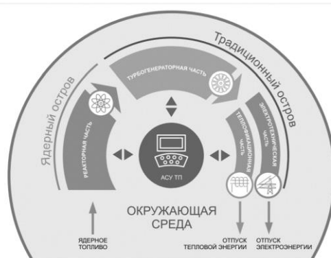
Рисунок 1 – Технология АЭС с ВВЭР
