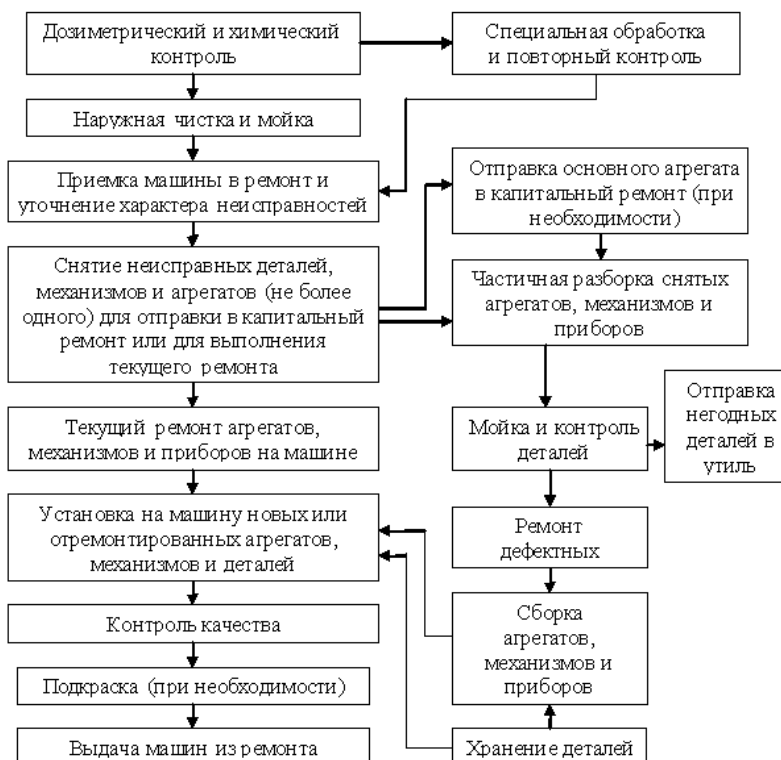
Рисунок 2.5 – Технологический процесс текущего ремонта машин
