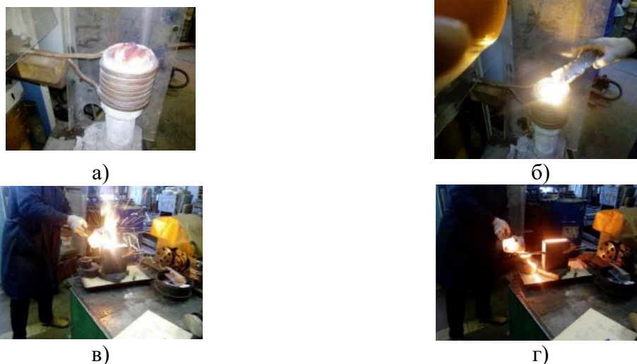
Рисунок 2 – Этапы плавки и заливки хромосилицистого чугуна: а – расплавление основной шихты; б – доводка по химическому составу; в – разливка в металлическую форму (кокиль); г-заливка пробы на химический анализ
