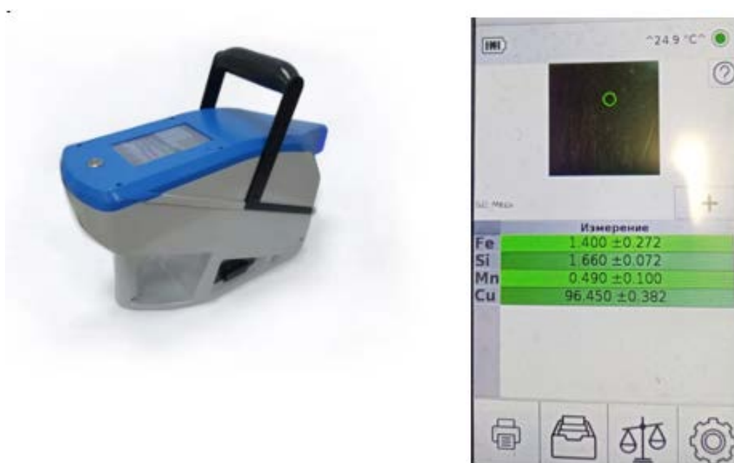
Рис 3. - Портативный лазерный спектрометр ЛИС – 01 и пример показаний, выдаваемых прибором.
