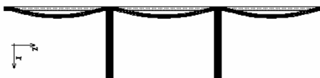
Рисунок 1 – Деформированное состояние при жестком закреплении торцов цилиндра
