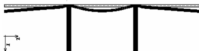
Рисунок 2 – Деформированное состояние при свободном опирании торцов цилиндра
