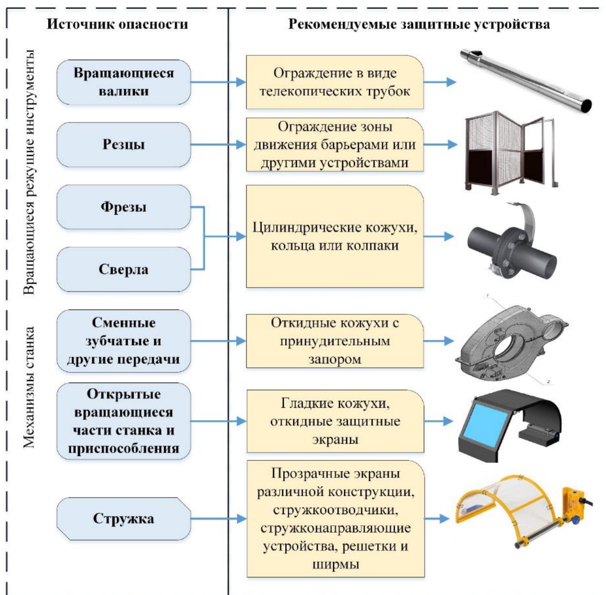
Рисунок 2 – Источники опасности и защитные устройства металлорежущих станков
