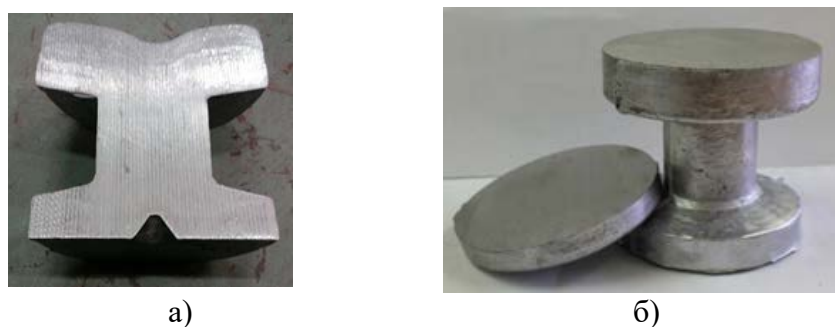
а – продольный разрез; б – поперечный разрез под прибыльной частью отливки Рисунок 8 – Макроструктура опытной отливки с высотой прибыли 20 мм:
