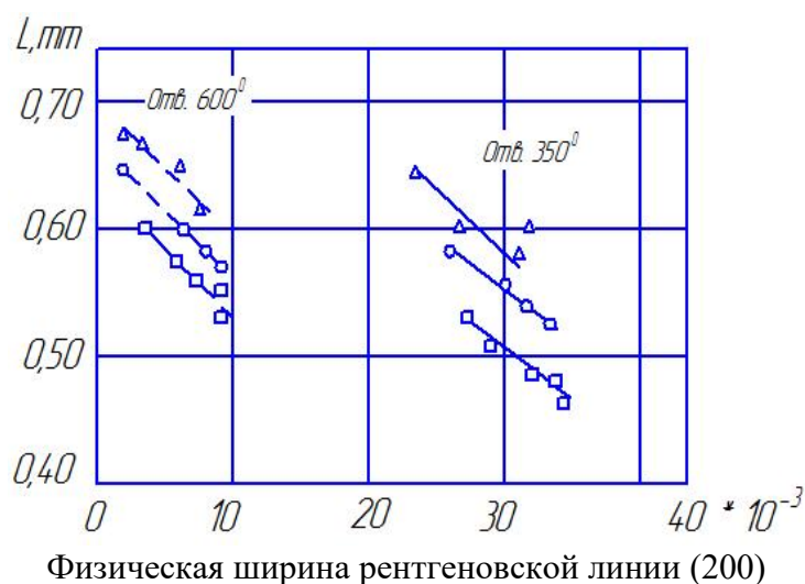
Рис. 1 - Зависимость абразивного износа (L) сталей Δ -35, о -45, □ -У8 от физической ширины рентгеновской линии.
