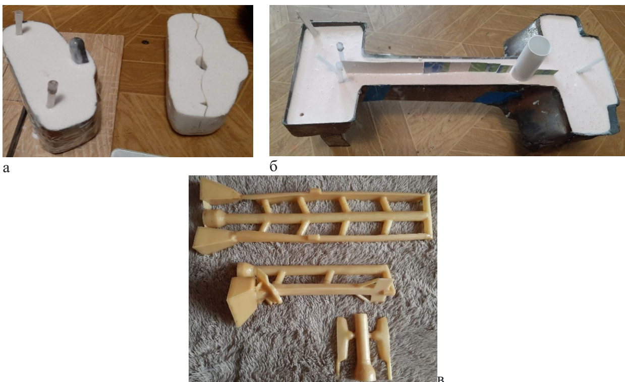
Рисунок 2 – Внешний вид эластичных форм (а, б) и полученных в них выплавляемых моделей (в).
