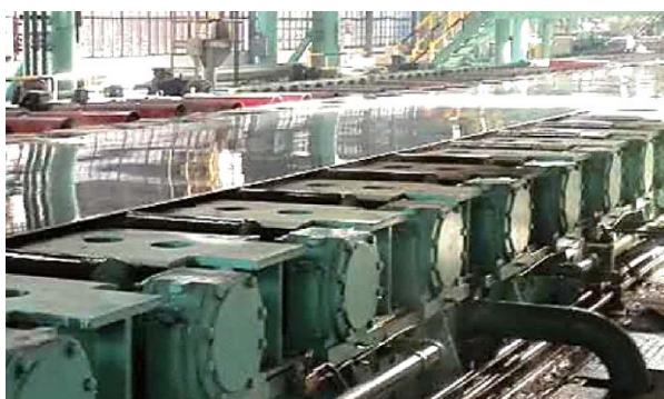
Рисунок 1 – Система сверхбыстрого охлаждения прокатанного стального листа
