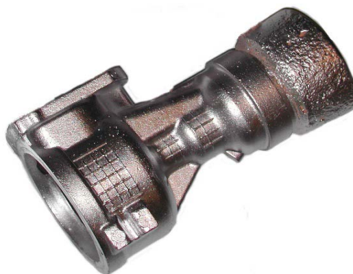
Рисунок 1 – Отливка из алюминиевого сплава, полученная литьем в кокиль
