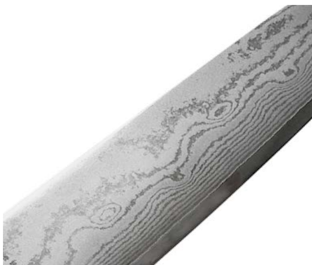
Рисунок 2. Пример структуры дамасской стали
