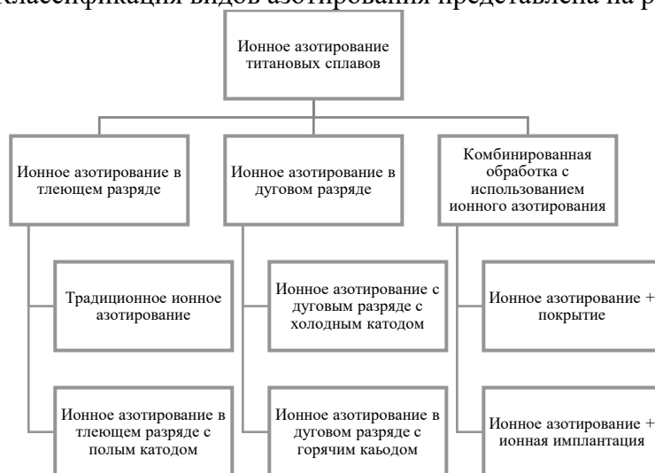
Рисунок 1 – Классификация основных видов ионного азотирования титановых сплавов [10].
