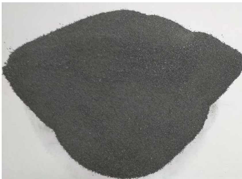
Рисунок 1 – Внешний вид порошка, полученного после металлургической переработки алюмоматричных кварцсодержащих композиций
