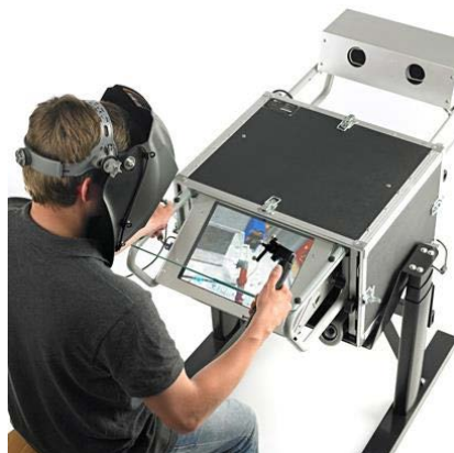
Рисунок 1 - сварочный тренажер 3D виртуальной реальности WELDPLUS
