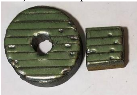
Рисунок 1 – фото экспериментальных образцов ПГ-СР4 (без нанокремниевых компонентов) после лазерного оплавления
