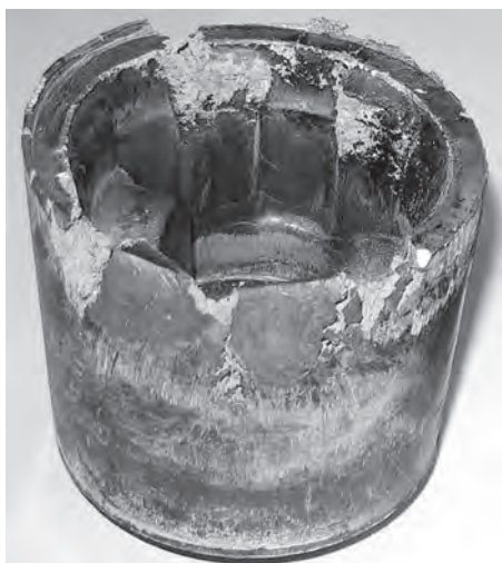
Рис. 5. Дефекты модельного образца поршня (незаполнение гравюры штампа и трещины)
