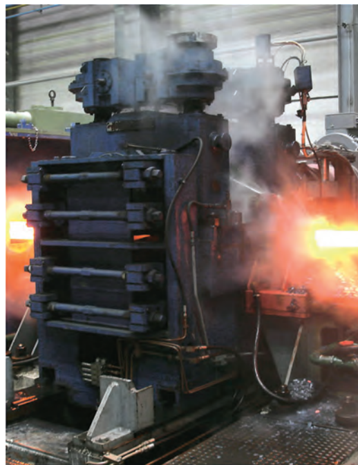
Рис. 2. Горизонтальная линия клетки 560 стана 280
