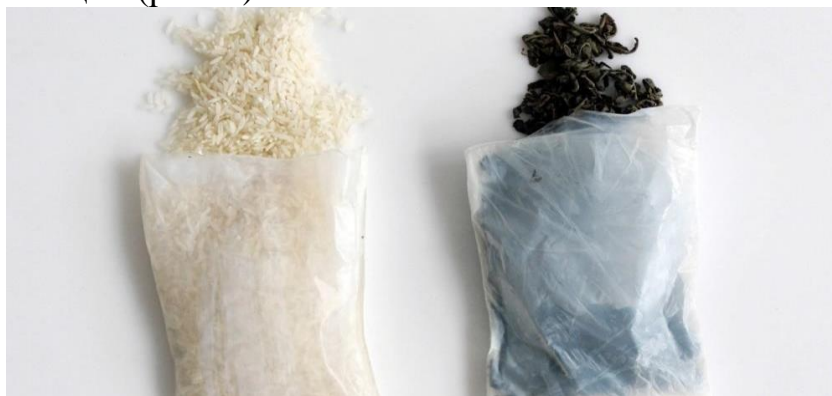
Рисунок 1– Съедобная упаковка, полученная методом ферментации
