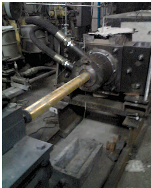
Рис. 2. Установка для непрерывного литья трубных заготовок
